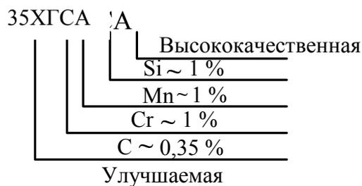
Рис. 2.26. Марка легированной конструкционной стали
