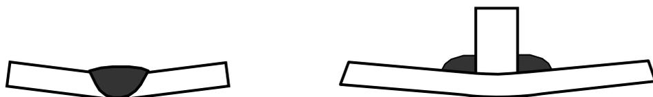
Рис. 7.36. Коробление при сварке
