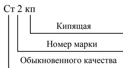
Рис. 2.23. Марка конструкционной стали обыкновенного качества
